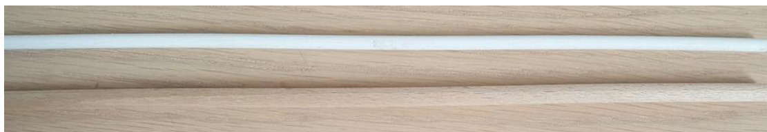
laminátové týblo nahoře, dřevěné dole, všimněte si, že laminátové je tenčí
