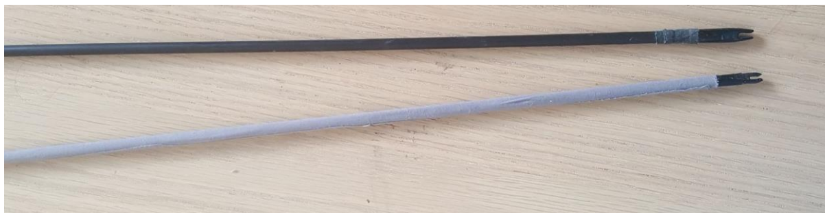
laminátová týbla s nasazenými končíky, horní obalené elektrikářskou bužírkou, spodní kobercpáskou
